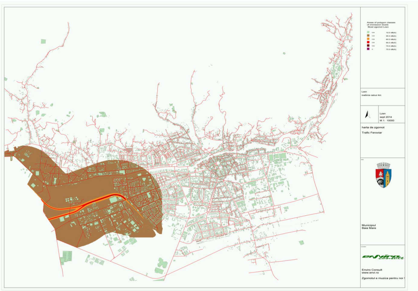
Figura 6.2 - 3 Hartă zgomot trafic feroviar în Municipiul Baia Mare – indicator Lzsn Sursa: Harta Strategică de Zgomot a Municipiului Baia Mare – anul 2014
